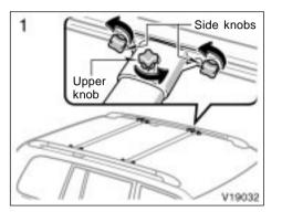
ADJUSTING THE POSITION OF CROSS RAILS:
